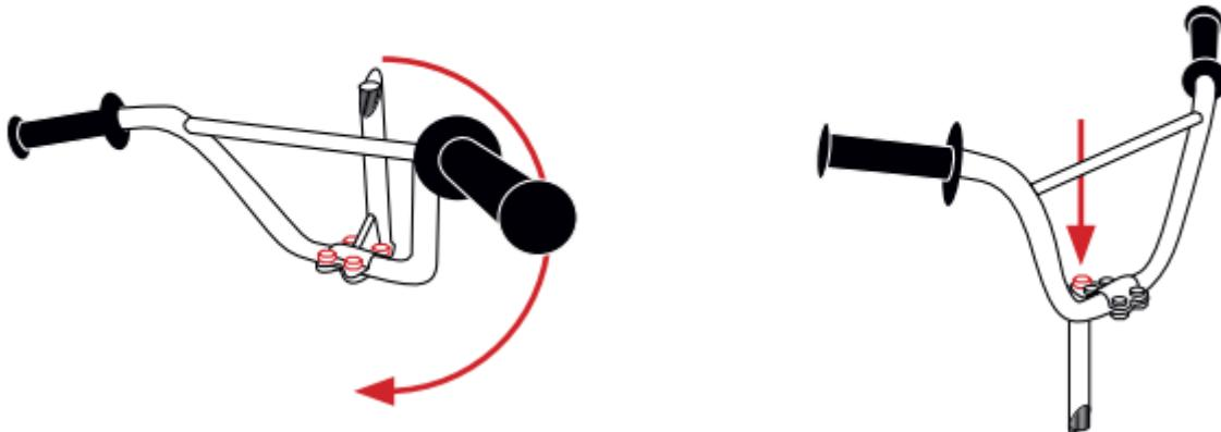
5. Vsuňte kormidlo – resp. tyč kormidla do rúrky pre kormidlo (obr. 4), nastavte výšku kormidla od zeme podľa potrieb jazdca, pri čom max. vysunutie je vyznačené na tyči kormidla, skontrolujte, či je os kormidla v osi s predným kolieskom a riadne dotiahnite skrutku (obr. 3).
