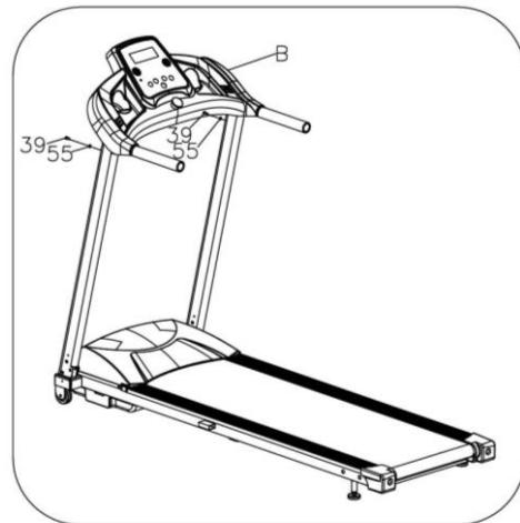
Zafixujte ovládací panel (B) na stípikoch pomocou skrutiek M8x15 (39) a istiacich podložiek (55) - skrutky utiahnite pomocou dodaného imbusového kľúča (5 mm).
