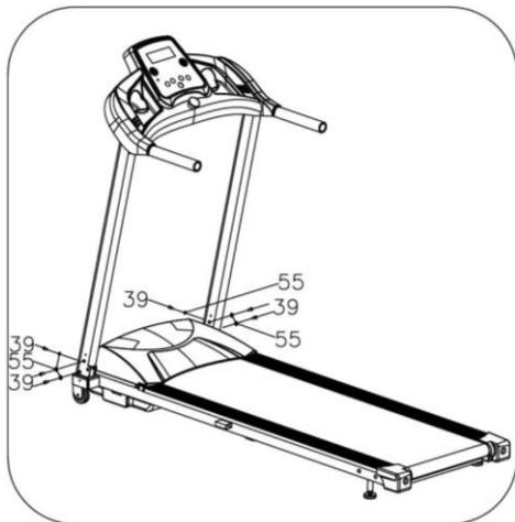
Zafixujte stípiky pomocou skrutiek M8x15 (39) a istiacich podložiek (55) - skrutky utiahnite pomocou dodaného imbusového kľúča (5mm).
