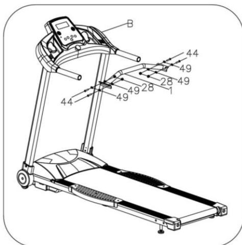
Pripevnite spojovaciu tyč (1) k ovládaciemu panelu pomocou skrutiek M8x50 (44), prehnutých podložiek (49) a matíc (28).
