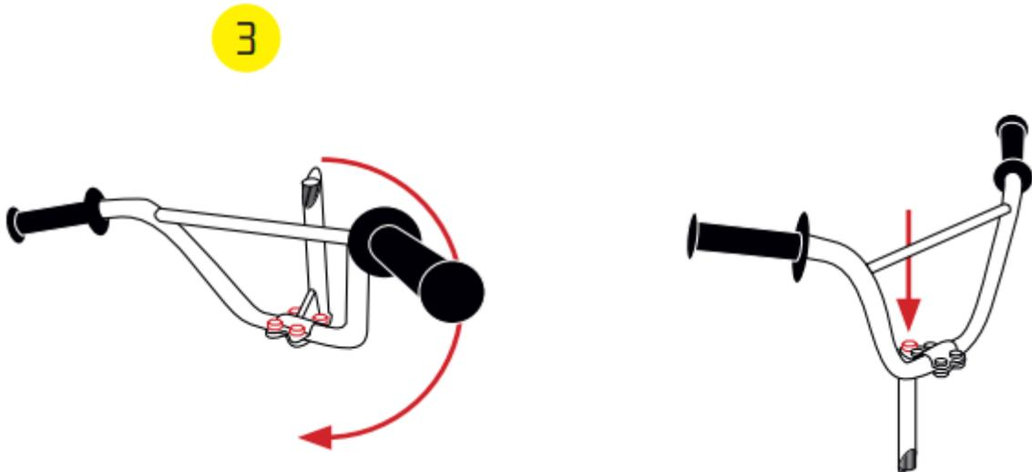
5. Vsuňte kormidlo – resp. tyč kormidla do rúrky pre kormidlo (obr. 4), nastavte výšku kormidla od zeme podľa potrieb jazdca, pri čom max. vysunutie je vyznačené na tyči kormidla, skontrolujte, či je os kormidla v osi s predným kolieskom a riadne dotiahnite skrutku (obr. 3).
