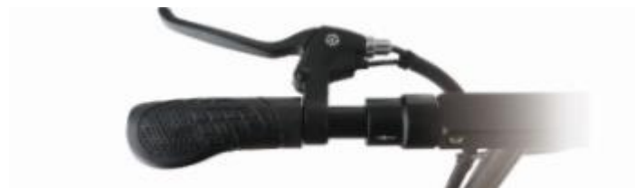
LED svetlo/Regulácia rýchlosti (doľava pomaly, doprava rýchlo)/Klaksón
