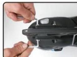
3) Odstráňte skrutky z otvorov a potom vytiahnite nôž von.
