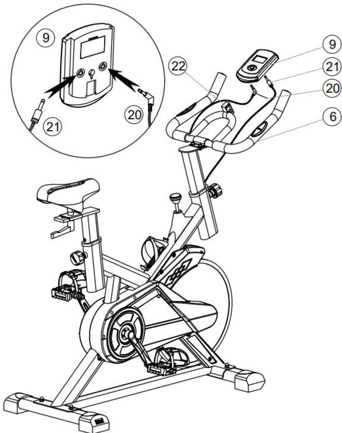
Zapojte signálny kábel A (20) a signálny kábel B (21) do dvoch otvorov na zadnej strane konzoly (09), ako je znázornené. Pripojte konzolu (09) k držiaku konzoly (22).
