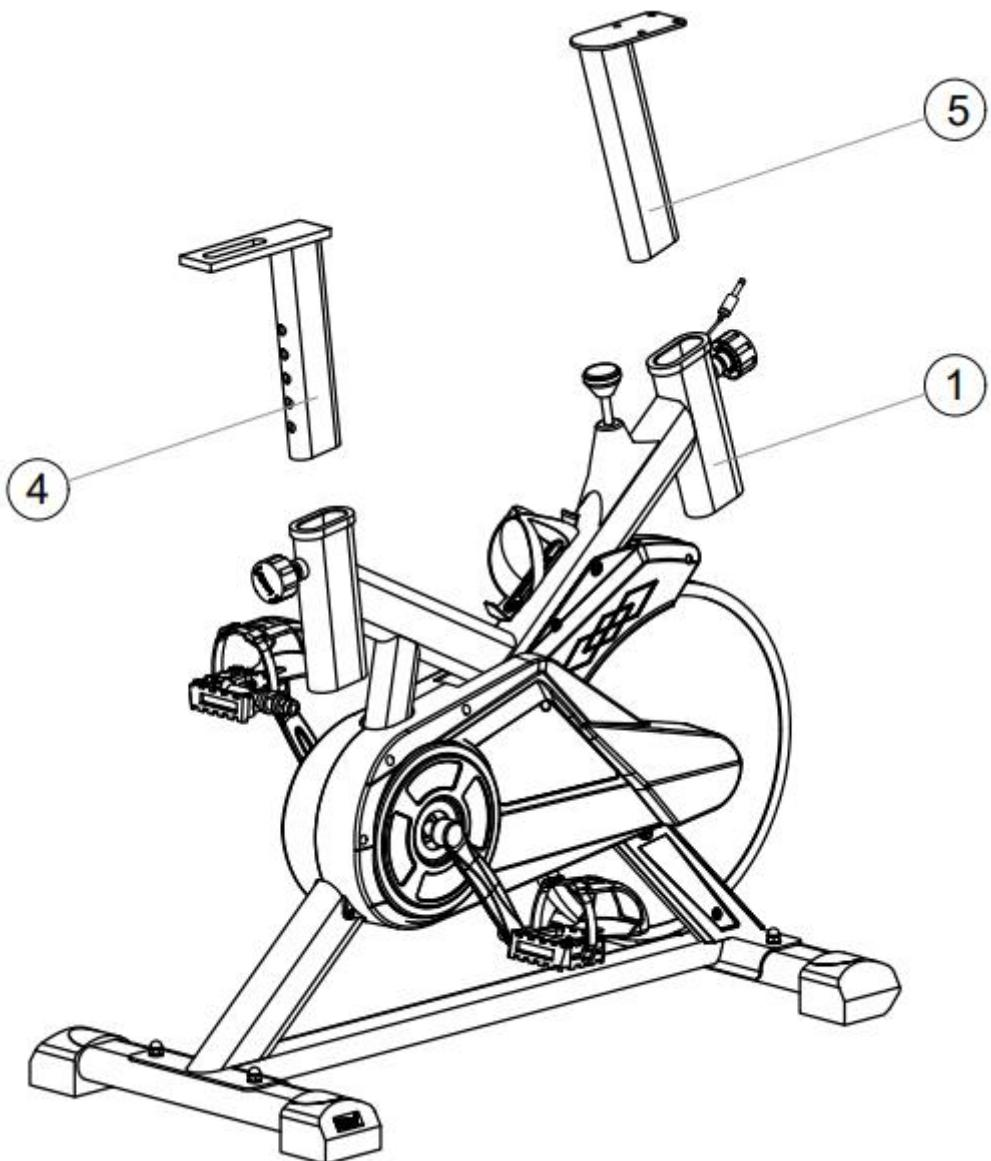
Vložte sedlovku (4) do zadného otvoru hlavného rámu (1) minimálne 4 palce, aby zapadla do najnižšieho otvoru sedlovky. Pred vložením sa uistite, že otvory na sedlovke (4) smerujú dozadu. Zaistite sedlovku (4) pomocou ručnej skrutky (14).
