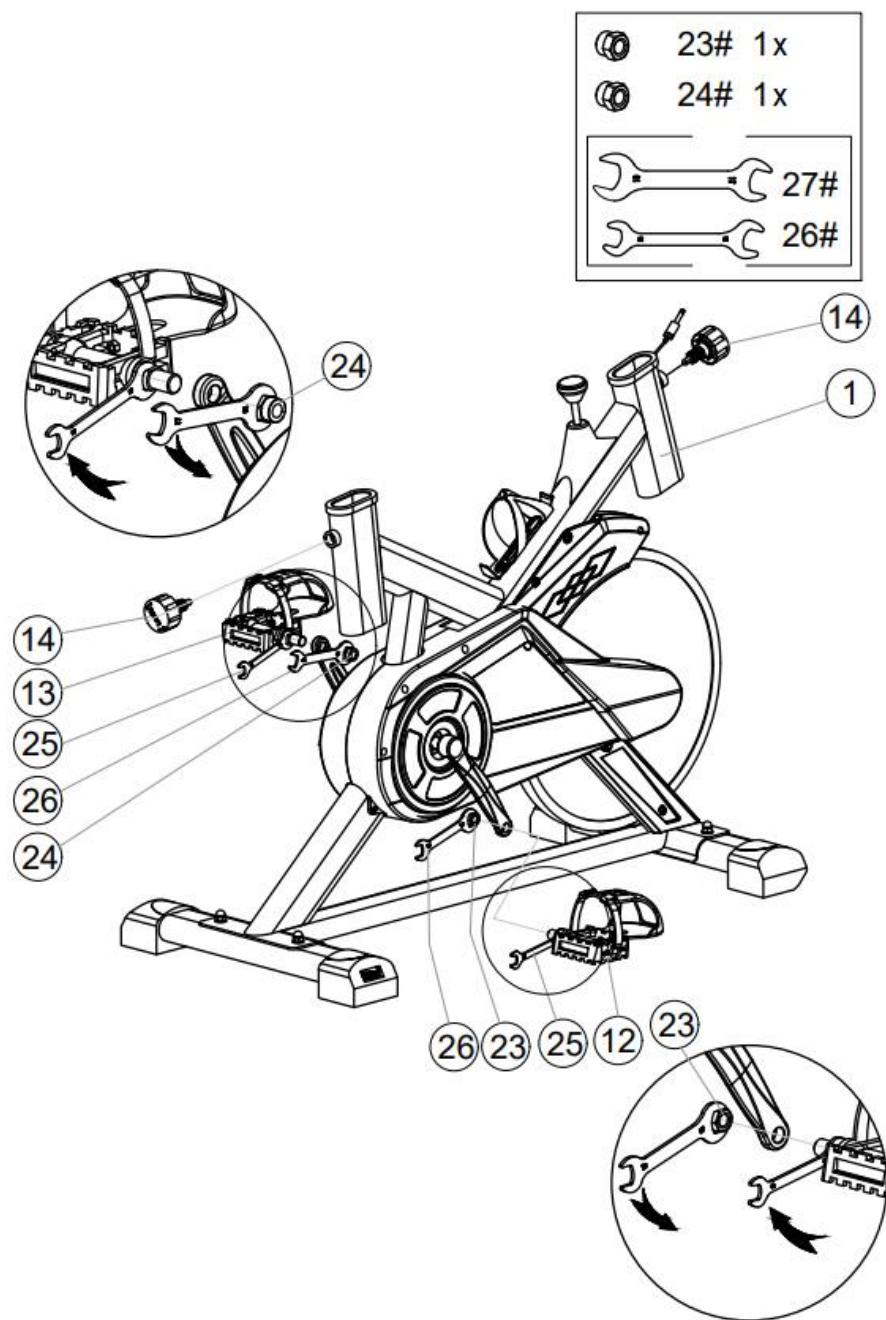
Na pravú stranu upevnite pravý pedál (12) so značkou R na kľuku a upevnite ho maticou R (23).
