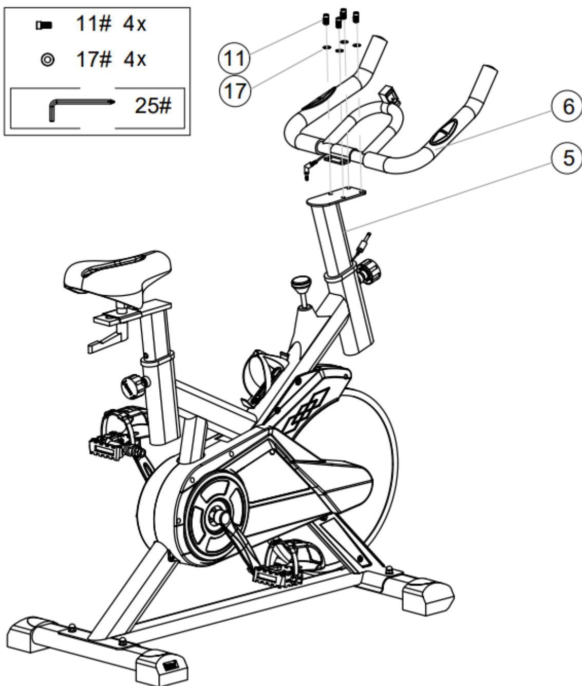
Pripevnite držadlá (6) k stĺpiku držadiel (5) pomocou štyroch podložiek (17) a štyroch skrutiek (11) a utiahnite imbusovým kľúčom (25).
