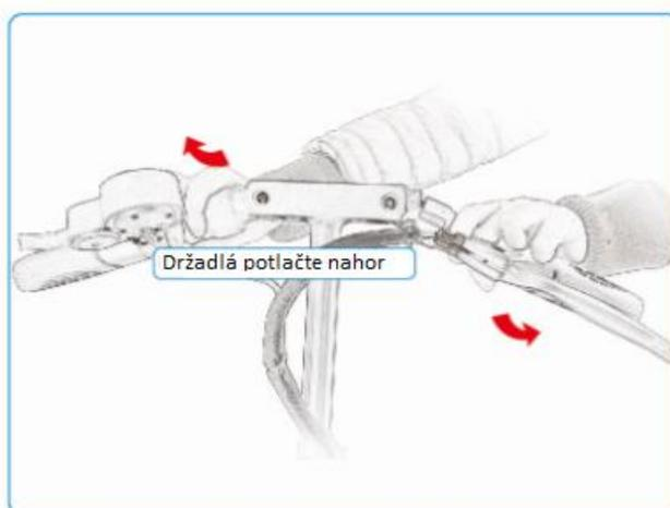
**POZNÁMKA:** Pred každým použitím preverte, či je poistka riadne zasunutá do centrálného sklápacieho mechanizmu. Inak riskujete zranenie alebo poškodenie prístroja.
