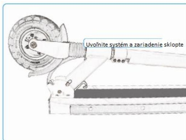
**POZNÁMKA:** Zariadenie je vybavené unikátnym sklápacím systémom, ktorý umožňuje rýchle a ľahké sklopenie pre optimálny prenos, prepravu alebo skladovanie.
