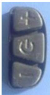
Krátkym stlačením ON/OFF tlačidla kolobežku spustíte. Potom môžete stlačením ON/OFF tlačidla prepínať medzi požadovaným zobrazením funkcií.
