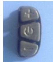
Pokiaľ je kolobežka vypnutá stlačte pre spustenie. Potom čo je kolobežka spustená stlačením tlačidla môžete prepínať medzi zobrazením: ODO (celková prejdená vzdialenosť), Trip (aktuálne prejdená vzdialenosť), RM, TM a Error (chyby).
