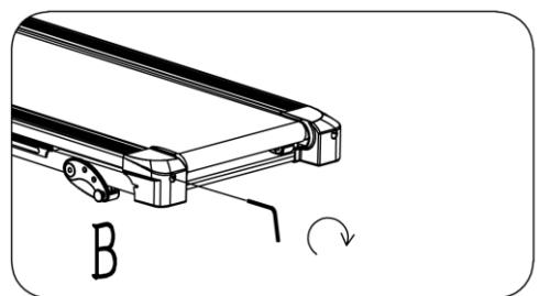
Bežecký pás sa priebehom času uvoľní. Aby ste ho znova utiahli, pootočte oboma nastavovacími skrutkami o celú otáčku. Skontrolujte utiahnutie pásu. Tento postup opakujte, kým nebude pás riadne utiahnutý. Dávajte si pozor, aby ste obe skrutky utiahli rovnakou mierou. Riadte sa podľa obrázku C.
