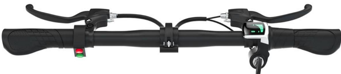
Kolobežku spustíte otočením kľúča, pre vypnutie otočte kľúčom do polohy pre vypnutie.
