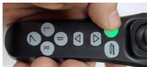
Podržte tlačidlo pre zníženie rýchlosného stupňa, kým sa ukazovateľ rýchlosného stupňa nerozsvietí na žlto.
