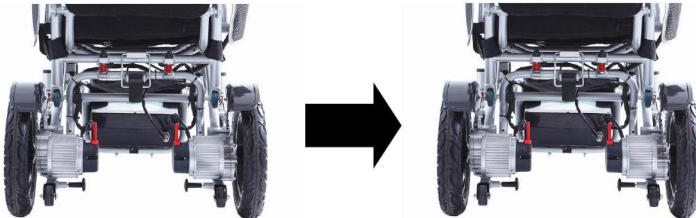
Opierky rúk zatlačte dole a pomocou otočného gombíka uzamknite otočením gombíka hore.
