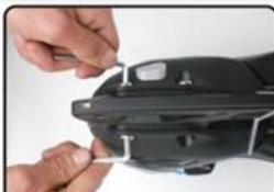
3) Odstráňte skrutky z otvorov a potom vytiahnite nôž von.
