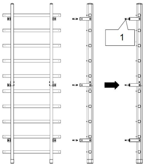
1. Pripevnite nosné skrutky M8 x 80 mm
