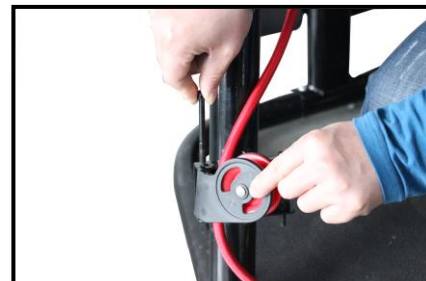
12- Nainštalujte elastické povrazy ku poličke na základni zariadenia.
