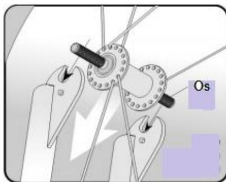
Nasuňte bezpečnostné podložky (Security Washer) (2) na os so závitom a zaistite, aby malé háčiky podložiek zapadli do určených otvorov vo vidlici. Upevnite predné koleso pomocou oboch ozubených osových matíc (Axe Nut) (3). Zaistite koleso v strede vidlice a utiahnite obe matice doporučeným uťahovacím momentom minimálne 20 Nm\*.
