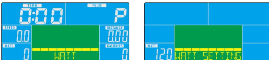
1. Pomocou tlačidiel UP a DOWN vyberte program WATT a pre vstup stlačte tlačidlo ENTER.
