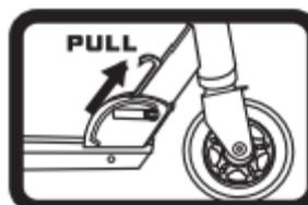
4. Potiahnite za páku a potiahnite tyč kormidla k doske.
