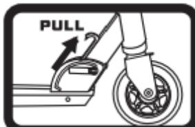
4. Potiahnite za páku a potiahnite tyč kormidla k doske.
