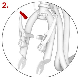
Kontrollera först att framgaffeln på skoter är korrekt inriktat (V-broms axlar ska peka framåt mot framsidan av skoter), släpp sedan bromskabel från guiden.
