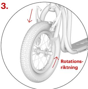
Sätt in hjulet i framgaffeln så att det är exakt i mitten. **Varning:** När du sätter i hjulet, se till att pilen på däcksidan pekar i rotationsriktningen när skotern rullar framåt.
