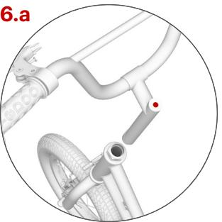
Assurez-vous que la languette du support est bien engagée dans l'orifice correct (voir le dessin) et resserez les deux écrous.
