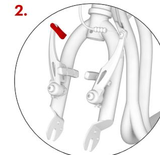
Stellen Sie sicher, dass die vordere Gabel des Rollers in die korrekte Richtung gedreht ist (die Arme der V-Bremse zeigen nach vorne) und nehmen Sie das Bremskabel aus dem Bremszug.
