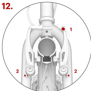
Stellen Sie sicher, dass der Abstand der Bremsbeläge von der Felge bei unbetätigtem Bremshebel etwa 1-2 mm beträgt. Der Abstand der Bremsbeläge kann durch das Festziehen bzw. Lockern des Bremsseils in der Fixierschraube reguliert werden (1). Falls der Reifen beim Drehen an irgendeiner Stelle streift, stellen Sie die Entfernung der Bremsarme durch die Spannschrauben (2) symmetrisch ein.
