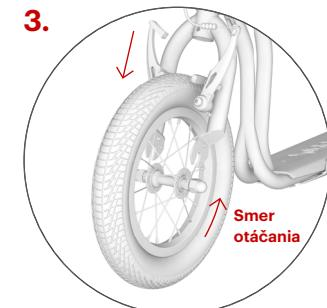
Koleso vsadte do prednej vidlice tak, aby bolo presne uprostred. **Pozor:** Vzor pneumatiky by mal smerovať dopredu v smere jazdy, viď smerová šípka na boku plášta.
