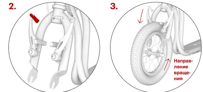
Проверьте, повернута ли передняя вилка в правильном направлении (рычаги ободного тормоза находятся впереди), затем ослабьте тормозной трос в хомуте.
