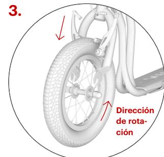
Inserte la rueda en la horquilla delantera de tal manera que quede exactamente en el medio. **Precaución:** Cuando inserte la rueda, asegúrese que la flecha en la banda de rodadura del neumático apunte en la dirección de rotación cuando el patinete se desplace hacia delante.
