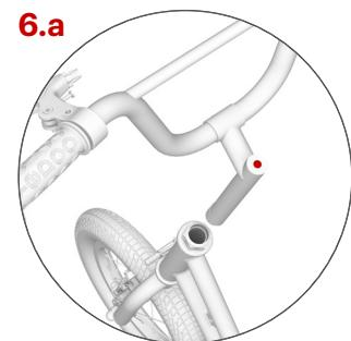
Inserte el vástago en el tubo del bastidor del patinete y ajuste la altura del manillar teniendo cuidado de no situarlo por encima de la línea marcada, véase img. 6b. Asegúrese que el manillar está recto y luego apriete el tornillo en el vástago.
