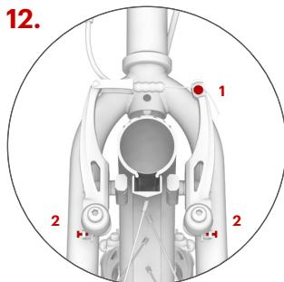
Controllare se quando si rilascia la leva del freno i pattini si allontanano sufficientemente dal cerchione (1-2 mm). La distanza tra i pattini può essere regolata tendendo oppure allentando il cavo del freno sul bullone di ancoraggio (1). Se girando, la ruota tocca i pattini del freno, regolare simmetricamente la distanza dei due braccetti del freno con l'aiuto delle viti di fissaggio (2).
