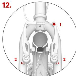
Vérifiez si les patins s'écartent suffisamment de la jante (1-2 mm) lors de la libération de la manette de frein. La distance des patins peut être ajustée en resserant ou en desserrant le boulon d'ancrage du câble de frein (1). Si la roue en tournant entre en contact avec le patin de frein, ajustez de manière symétrique la distance des bras de frein à l'aide des vis de tension (2).
