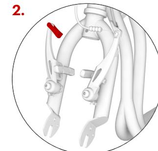
Primero verifique que la horquilla delantera del patinete está correctamente alineada (los brazos del freno en V deben apuntar hacia adelante, hacia la parte frontal del patinete), luego suelte el cable del freno de la guía.
