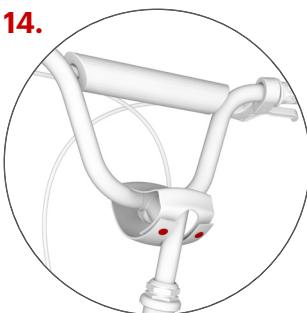
Sprawdź, czy klocki hamulcowe odsuwają się od obręczy w dostatecznym stopniu (1-2 mm), kiedy dźwignia hamulca zostanie zwolniona. Odległość klocków hamulcowych można regulować poprzez dokręcenie lub poluzowanie śruby mocującej linkę hamulca (1). Jeśli klocki hamulcowe wchodzą w kontakt z obręczą w czasie, kiedy koto się obraca, ustaw odstępy ramion hamulców symetrycznie za pomocą śrub regulujących (2).
