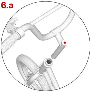
Sätt in spindeln i ramröret av skoter och justera styrets höjd noga, och inte placera den ovanför den markerade raden, se bild. 6b. Se till att styret är raka och sedan dra åt skruven på spindeln.
