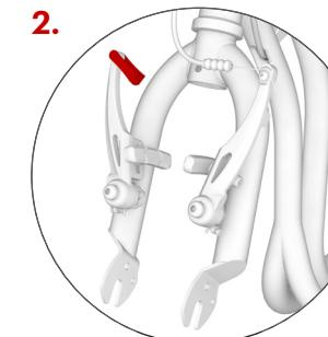
Skontrolujte, či je predná vidlica kolobežky natočená v správnom smere (ramená V-brzdy smerujú dopredu) a uvolnite brzdové lanko z vodítka.
