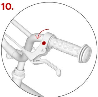
**Regolazione dell'inclinazione delle leve del freno**
