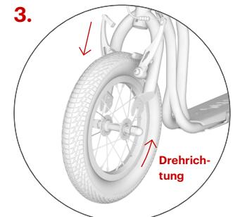
Setzen Sie nun das Rad in die Vordergabel ein. Es sollte sich genau in deren Mitte befinden. **Vorsicht!** Das Reifenprofil sollte in Fahrtrichtung nach vorne zeigen, siehe das Pfeil an der Seite des Reifenmantels.
