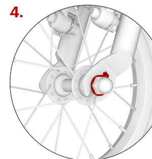
Uistite sa, že zobáčik podložky zapadol do správneho otvoru a potom dotiahnite obidve matice.
