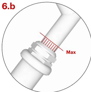
Den högsta möjliga höjd på styret är märkt med vertikala spår, vid den maximala höjden spåren ska vara synliga endast delvis.
