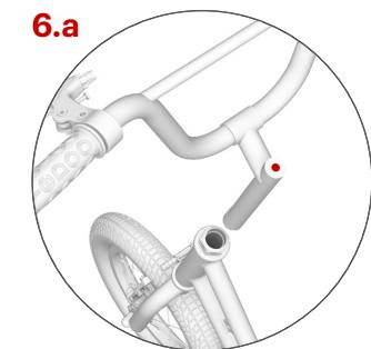
Inserire l'asta del manubrio nel tubo dello sterzo del monopattino e regolare l'altezza desiderata, senza oltrepassare la tacca (vedi fig. 6b). Controllare che il manubrio sia diritto (perpendicolarmente all'asse della ruota) e serrare la vite sull'asta.
