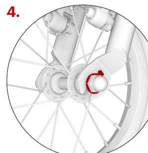
Stellen Sie sicher, dass der Schnabel der Unterlage an der richtigen Stelle eingrastet ist und ziehen Sie dann beide Muttern fest.
