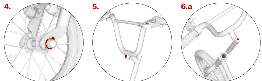
Убедитесь, что выступ шайбы попал в нужное отверстие и тогда затяните обе гайки.
