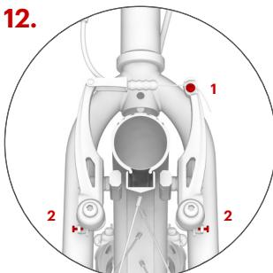
Skontrolujte, či sa doštičky pri uvoľnení brzdovej páčky dostatočne oddialia od ráfika (1-2 mm). Vzdialenosť doštičiek sa dá upraviť pritiahnutím či povolením brzdového lanka v kotevnej skrute (1). Pokiaľ sa koleso pri otáčaní v niektorom mieste dotýka brzdových doštičiek, symetricky upravte vzdialenosť brzdových ramien napínacími skrutkami (2).
