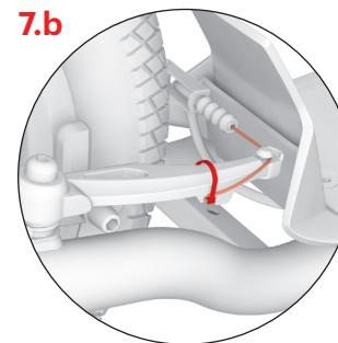
Отпустите рычаг тормоза. Прокрутите колесо несколько раз. Убедитесь, что оно не задевает за тормозные колодки. Между колодками и ободом должен быть просвет 1-2 мм. Расстояние можно регулировать путем затягивания или ослабления винта на тормозном тросе (2). В случае, когда тормозные колодки касаются колеса при повороте, отрегулируйте расстояние между тормозными рычагами и колесом с помощью винта (3).
