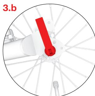
Установка заднего колеса в верхнем положении позволяет установить ножную платформу ниже. В результате уменьшается нагрузка на опорную ногу, и езда становится менее утомительной. Это идеально для катания на ровных поверхностях.
