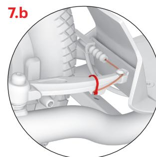
Zkontrolujte, zda se špalíky při uvolnění brzdrové páčky dostatečně oddálí od ráfku (1–2 mm). Vzdálenost špalíků lze upravit přítažením či povolením brzdrového lanka v kotevním šroubu (2).
