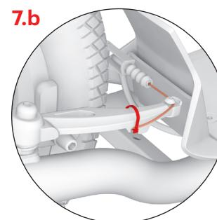
Überprüfen Sie, dass der Abstand der Bremsbeläge von der Felge bei unbetätigtem Bremshebel etwa 1-2mm beträgt. Dieser Abstand lässt sich durch anziehen oder lockern des Bremsseils in der Fixierschraube (2) regulieren. Falls der Reifen beim drehen an irgendeiner Stelle den Bremsbelag streift, stellen Sie die Entfernung der Bremsarme durch die Spannschrauben (3) symmetrisch ein.
