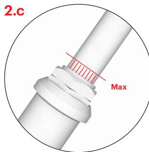
Максимальная высота руля обозначена вертикальными канавками, которые в наивысшем положении должны быть видны только частично.
