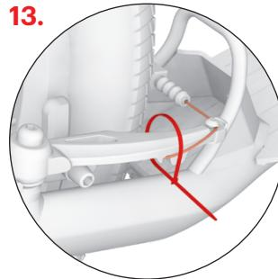
Biegen Sie das Ende des Bremsseiles so, dass es das Kind nicht stört wenn es fährt (gilt für die vordere und hintere Bremse).
