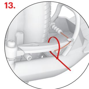
Konec brzdového lanka zafixujte do zámku a zabezpečte stahovací páskou, pásku poté zastříhněte (platí pro přední i zadní brzdu).
