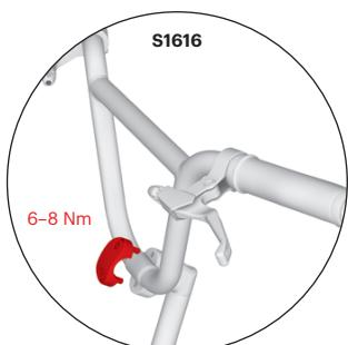
Затяните настроечную гайку эксцентрика так, чтобы перед закрытием рычажка эксцентрика вы почувствовали значительное сопротивление. Рычажок закройте в таком положении, чтобы он не прикасался к вилке, и в то же время чтобы исключить его случайное открытие во время езды.
