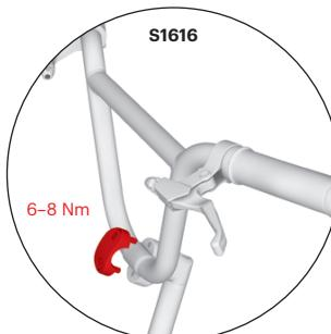
Dotiahnite nastavovaciu maticu rýchlopínacieho tak, aby ste tesne pred dovrstvím rýchlopínacej páčky cítili značný odpor. Páčku zavrite a by sa nedotýkala vidlice a zároveň nemohlo dôjsť k jej náhodnému otvoreniu počas jazdy.
