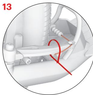
Koniec brzdového lanka zafixujte do zámku a zabezpečte stahovacou páskou, pásku potom zastríhnite (platí pre prednú aj zadnú brzdu).
