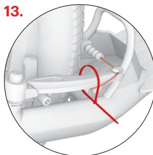
Закрепите конец троса тормоза в замке и закрепите его затяжным хомутом, затем отрежьте лишний конец (относится как к передним, так и к задним тормозам).
