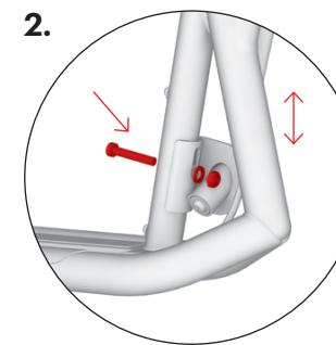
Stojánek namontujte na rám vpředu do připraveného otvoru, viz obrázek. Než šroub utáhnete, ujistěte se, že je umístěn na středu objímky. Oválný otvor v objímce umožňuje uzpůsobit výšku stojánu tak, aby danému modelu poskytl co největší stabilitu.
