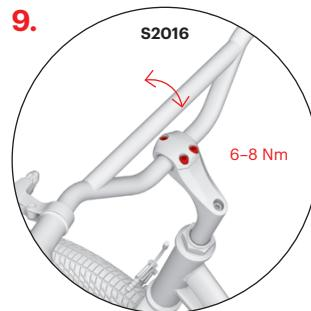
**Регулировка наклона руля**
