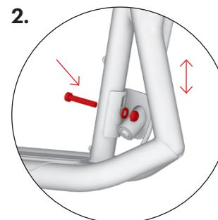
Установите подставку на переднюю часть рамы в подготовленное отверстие в соответствии с рисунком. Прежде чем затянуть болт, убедитесь, что он расположен в центре муфты. Овальное отверстие в муфте позволяет отрегулировать высоту подставки так, чтобы обеспечить этой модели максимальную устойчивость.
