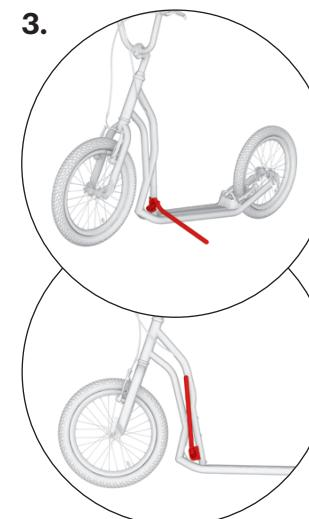
Der Ständer sollte in Fahrposition mit dem Rahmen des Tretrollers abschließen.
