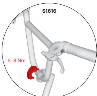
Dotáhněte seřizovací matici rychloupínáku tak, abyste těsně před dovršením rychloupaci pásky cítili znatelný odpor. Páčku zavřete v takové pozici, aby se nedotýkala vidlice a zároveň nemohlo dojít k jejímu náhodnému otevření během jízdy.
