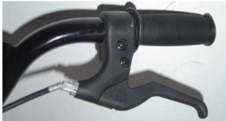
2. Zastrčte lanko do drážky v nastavovacej skrutke brzdovej páčky a uvoľnite zovretie brzdových čeľustí. Brzdové lanko sa následne vypne a koncovka bovdenovho kábla zapadne do nastavovacej skrutky brzdy.
