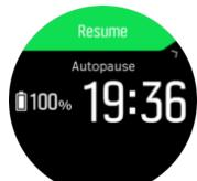
Zaznamenávanie môže pokračovať automaticky, keď sa znova začnete pohybovať, alebo manuálne z vyskakovacej obrazovky stlačením horného tlačidla.
