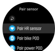
4. Podľa pokynov v hodinkách dokončite párovanie (v prípade potreby si pozrite návod pre snímač alebo zariadenie POD), pričom na ďalší krok vždy prejdete stlačením stredného tlačidla.
