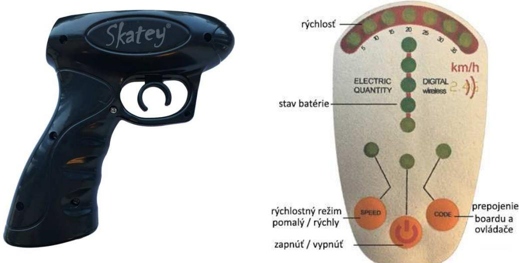
Tlačidlo pre Zapnutie / Vypnutie ovládača nájdete na hornej časti ovládača. Akonáhle ho stlačíme, všetky LED diódy zablikajú. Následne sa rozsvieti LED nad nápisom "CODE" - skateboard a diaľkový ovládač sú spárované. Ak LED nad nápisom "CODE" bliká, je spojenie medzi skateboardom a ovládačom prerušené - v tom prípade stlačte tlačidlo CODE, potom tlačidlo a spojenie sa obnoví. Ak sa skateboard chová neštandardne, ovládač zapnite a vypnite. Ak sa spojenie často přeruší,
