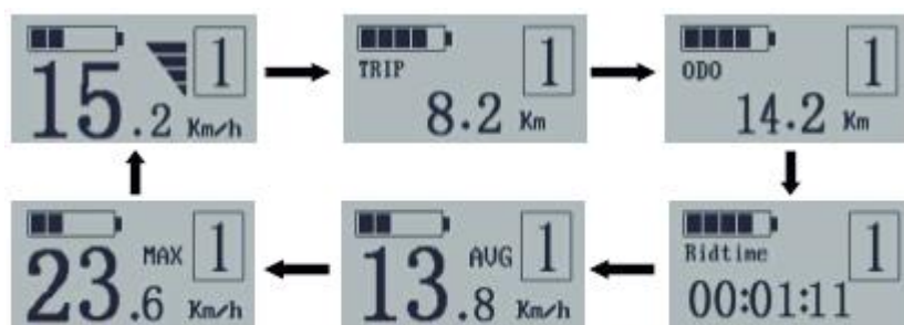
Spínač režimu rýchlosti a spínač režimu prejdenej vzdialenosti
