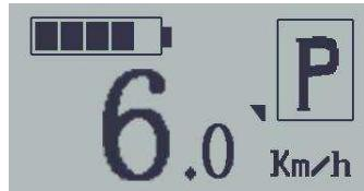
\* Tato výpomoc môže byť použitá len pri tlačení elektrobicykla. Hrozí nebezpečenstvo úrazu, pokiaľ nie sú pri spustení výpomoci tlačenia kolesá v kontakte so zemou.
